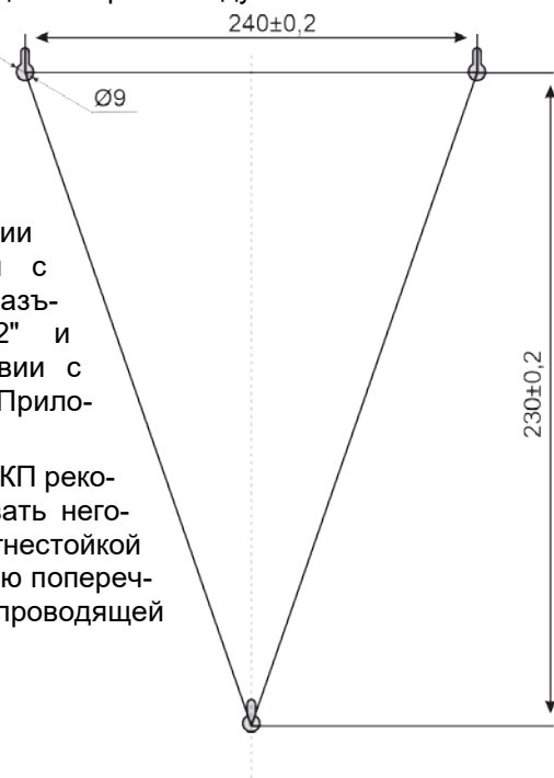
Рисунок 9 Разметка расположения отверстий крепления моноблока (усилителя)
